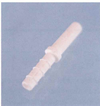
Dünnwandig und filigran: mit dem CIM-Pro-Verfahren hergestellte Hülse aus Al 2 O 3 .
